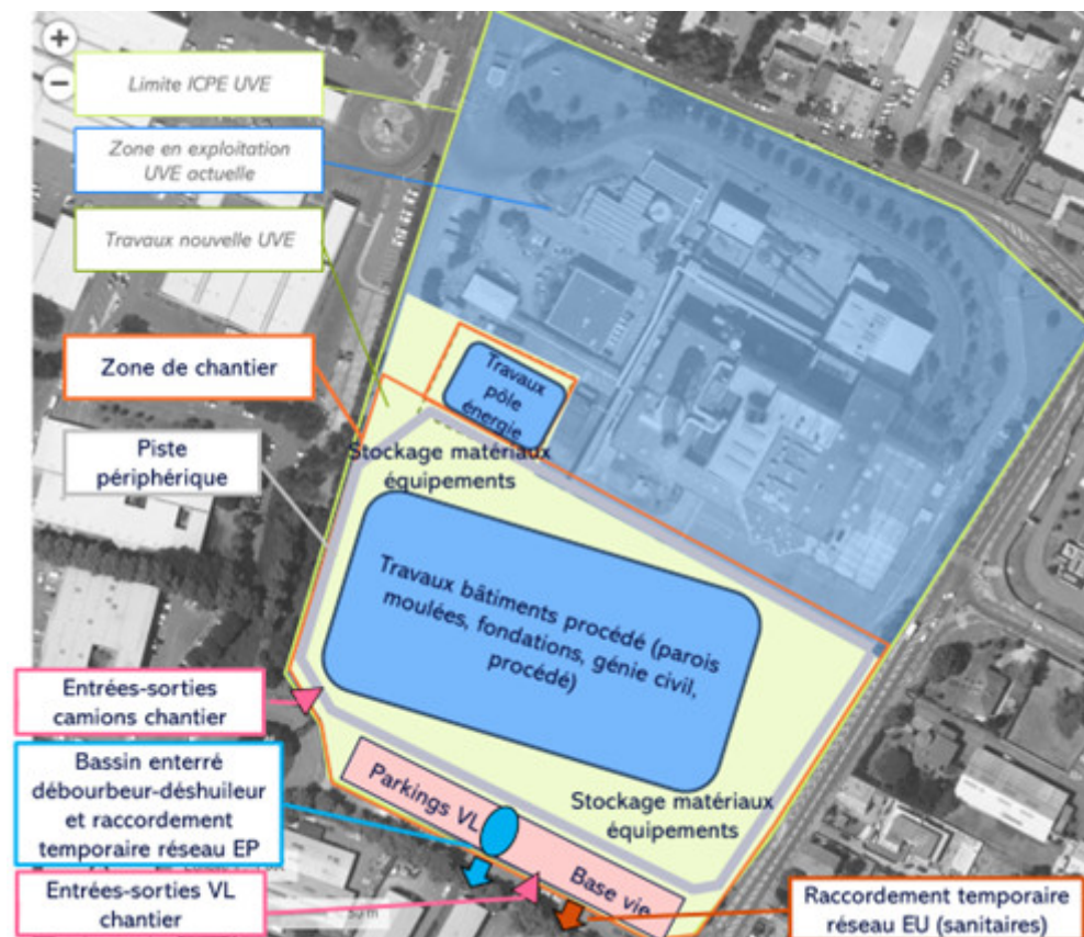
Figure 18 : Schéma de principe de l'organisation du chantier
