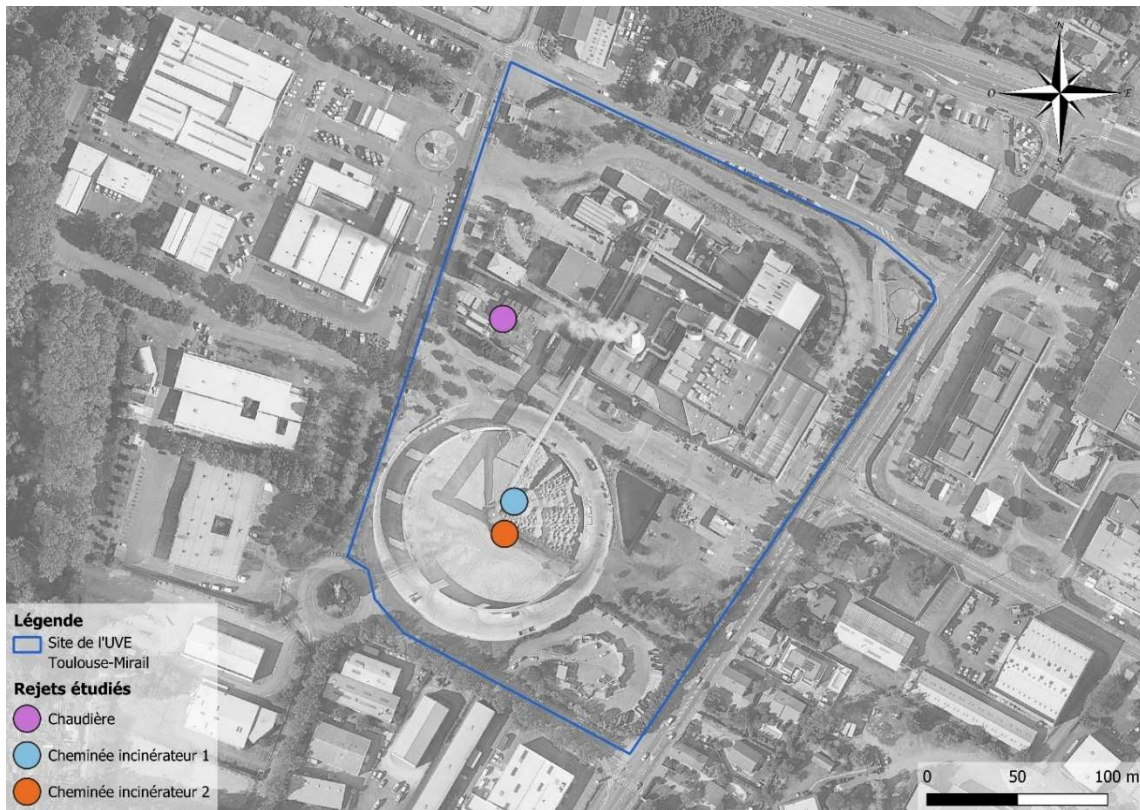
Figure 3 : Localisation des rejets canalisés
