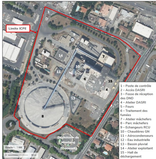
Figure 1 : implantation des principales fonctionnalités de l'UVE actuelle
