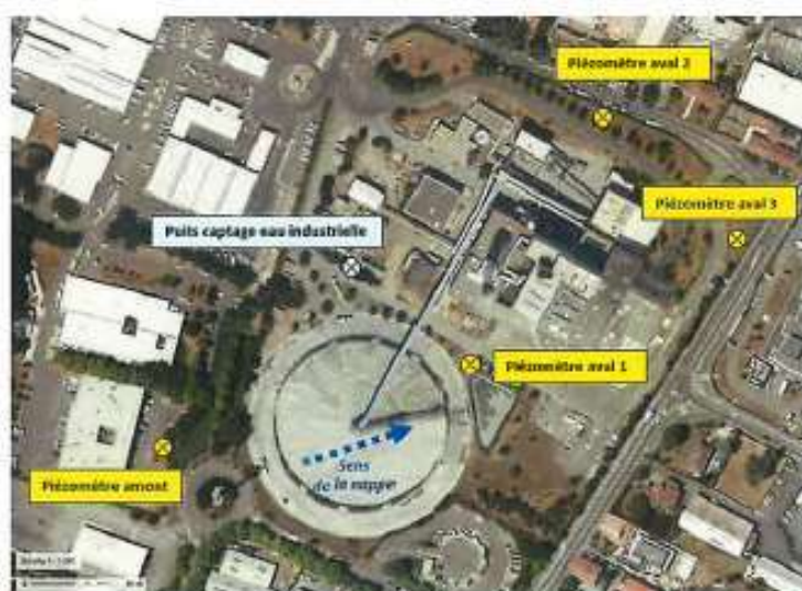
Figure 121 : Implantation du puits de captage et des piézomètres de surveillance de l'UVE actuelle
